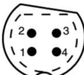
Vue embase mâle Côté câblage
